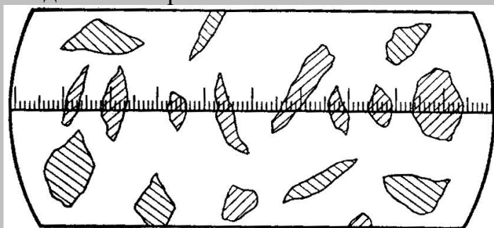
Рисунок 43 – Определение фазового состава линейным методом Розиваля
