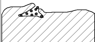
7-подповерхностная коррозия
