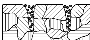
9-транскристаллитная коррозия
