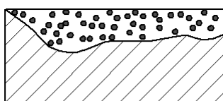
2-неравномерная коррозия
