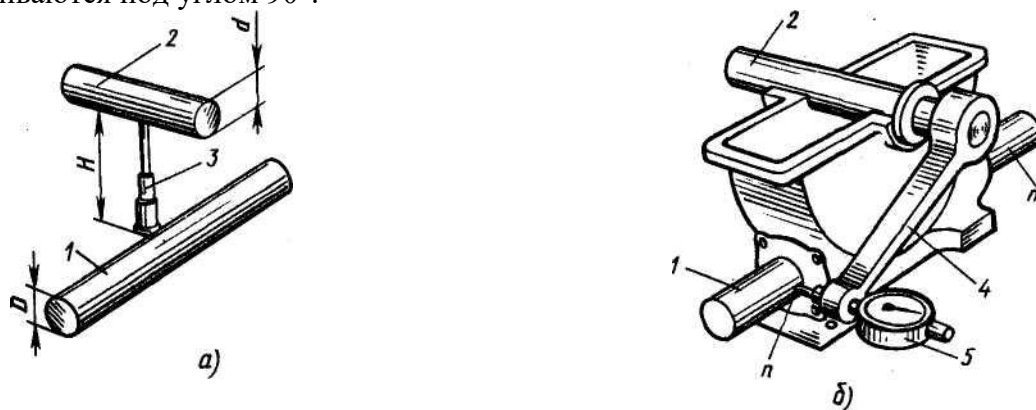
Рис. 53. Контроль расположения осей отверстий в корпусе червячного редуктора выполнением проверок: а — межосевого расстояния, б — угла скрещивания осей; 1, 2 — специальные оправки, 3 — микрометрический нутромер, 4 — рычаг, 5 — индикатор
